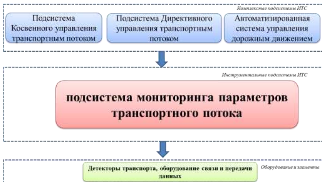
Рисунок 10 - Схема физической архитектуры локального проекта ИТС по Технические измерения дорожного движения
